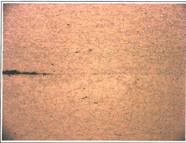
foto 5 attacco HF0.5% - ingrandimenti 100 x biella: rottura in sezione – esame micro.
