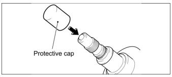
1. INSTALL THE PINION SHAFT PROTECTIVE CAP
