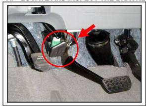
. VISUALLY INSPECT THE BRAKE LIGHT (STOP LAMP) SWITCH MOUNTING BRACKET SHAPE
