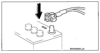
1. CONNECT THE NEGATIVE (-) BATTERY TERMINAL CABLE
