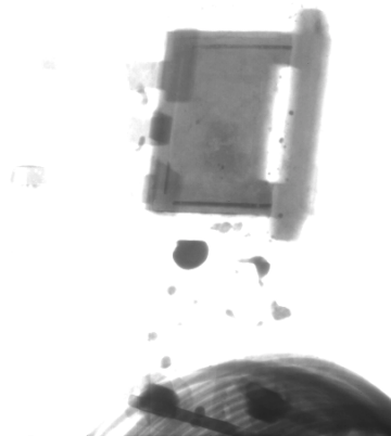
Abbildung 17: Radioskopische Untersuchung, IGBT Ansicht
