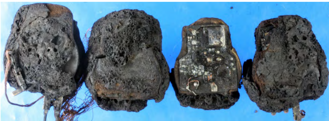
-1 -2 -3 -4 Abbildung 2: Spulenkopf Draufsicht
