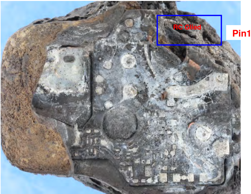
Abbildung 11: 11-z-10-02246_10, Schädigung des Spulenkopfes im Bereich des RC-Gliedes
