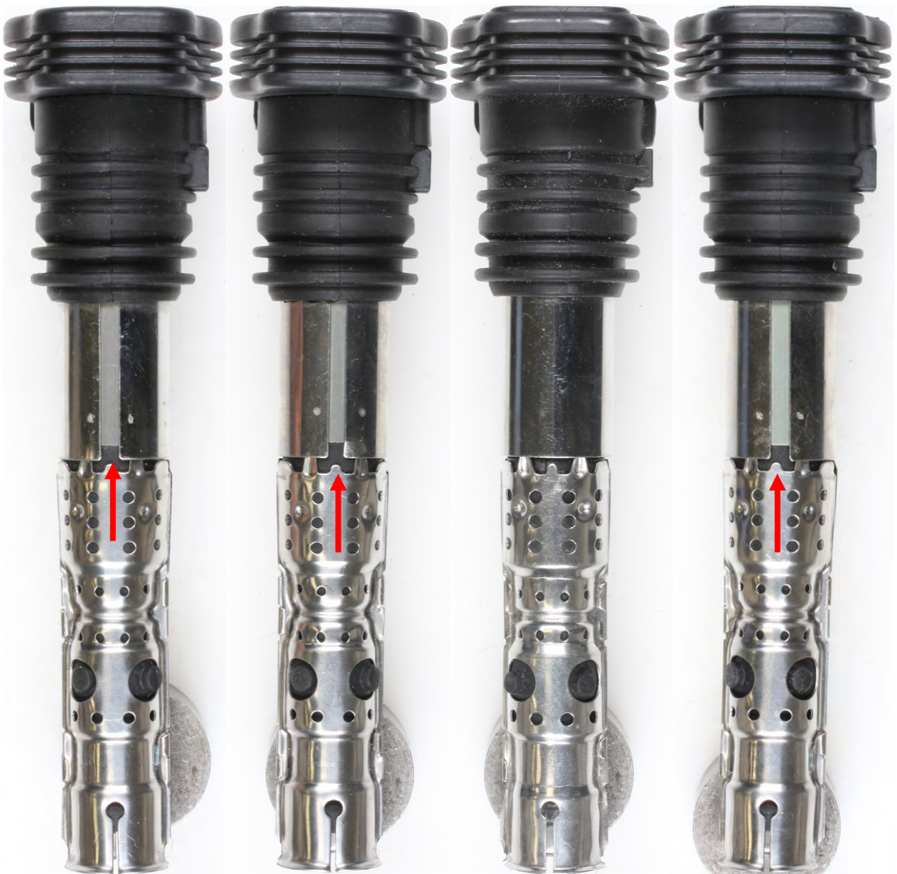
Abbildung 3: Spulenübersicht, Markierung: unterschiedliche Lage des Rückschlußblechs
