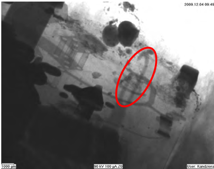
Abbildung 6: Platine, RC-Glied Bereich mit Massefeder: Teilerstörung der Massefeder in der Leiterplatten-Bohrung.
