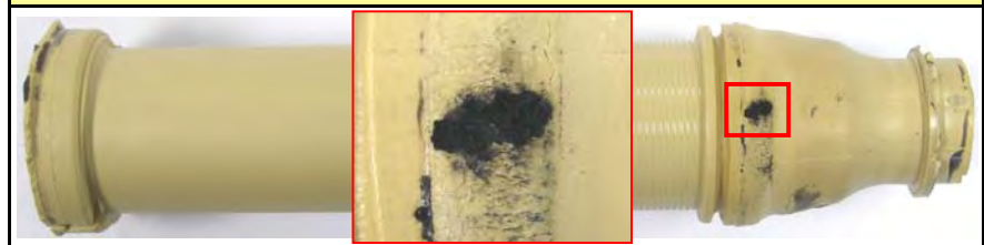
Primärspulenkörper - Durchschlag am aufgeschmolzenen HS-Rüssel
