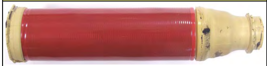
Spulensystem komplett - HS-Rüssel thermisch deformiert
