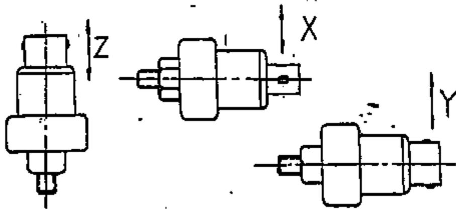
VIBRATION TEST - SWITCH ORIENTATION
