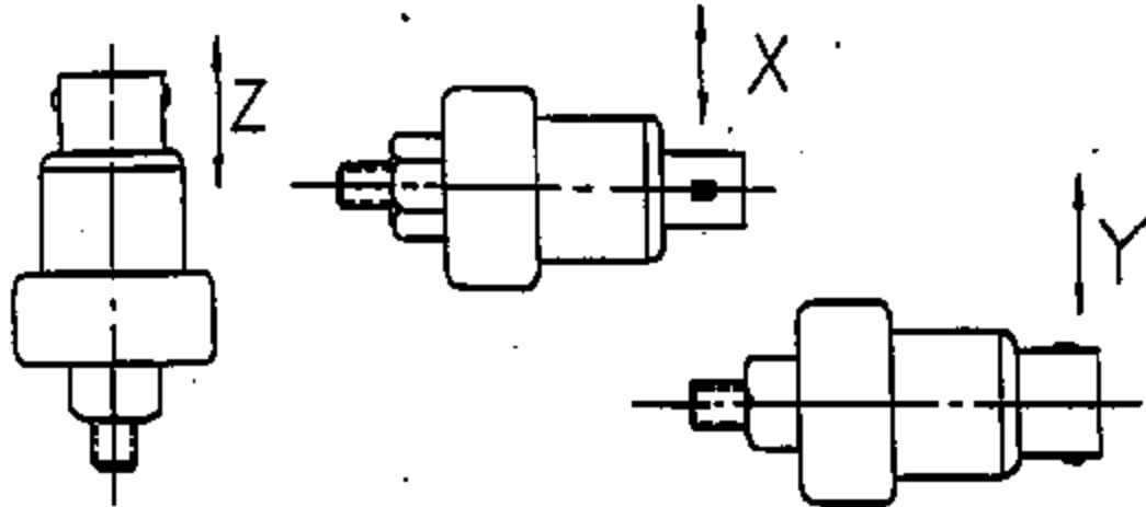
**VIBRATION TEST - SWITCH ORIENTATION**
