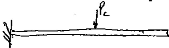
$$G = \frac{P_c a^2}{6EI} (3L - a) \quad \text{or} \quad P_c = \frac{6EIG}{a^2(3L - a)}$$
