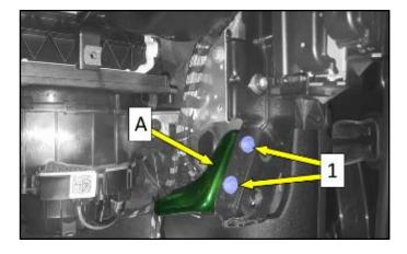
Install bracket <A> (if equipped) and torque bolts <1> to 9 Nm.
