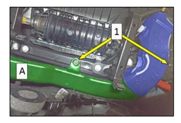
• Install air guide channel <A> and torque bolts <1> to 3 Nm.
