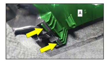
Position air intake housing <A> onto the mounts <arrows>
