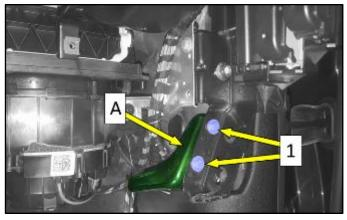
Remove bolts <1> and remove bracket <A> (if equipped).
