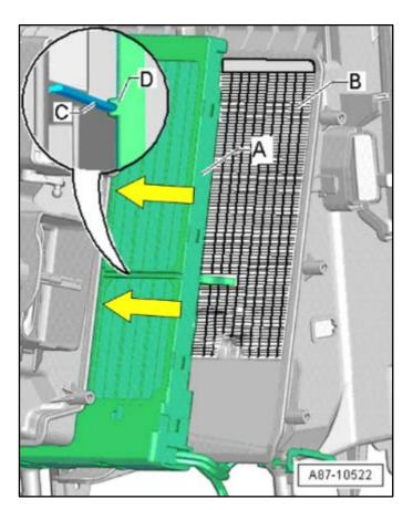
Install new Auxiliary Heater Heating Element -Z35- <A>.
